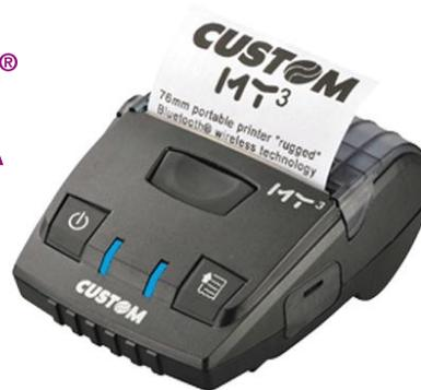
La impresora MY<sup>3</sup> A fue creada por Custom para uso profesional. Imprime en papel de 76mm de ancho con un espesor de hasta 100gr/m<sup>2</sup>. Cuenta con una velocidad de impresión de hasta 75mm/seg., sensores de fin del papel y de temperatura del cabezal, además de que soporta 4 logotipos personalizados de 576 x 450 puntos e imprime los códigos de barras 1D más comunes, así como los códigos 2D PDF417 y Datamatrix.
